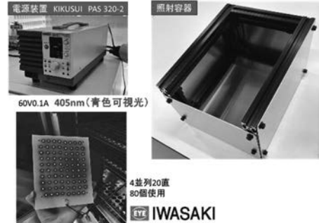
図1 実験装置 (細胞光照射器405nm)
