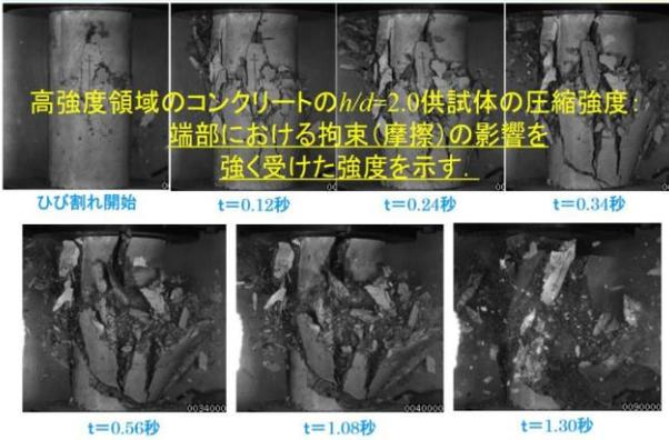
写真-5 高強度コンクリートの破壊状況 (f'c=100N/mm<sup>2</sup>) \*5
